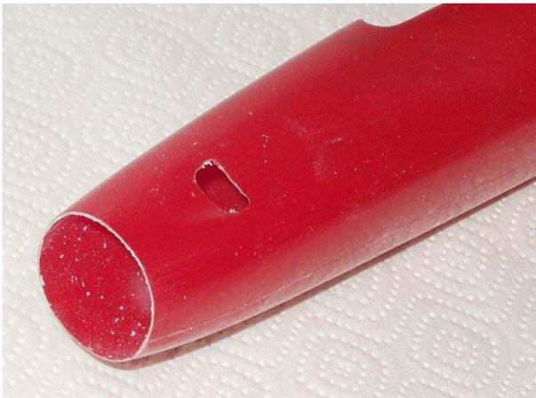
Lüftungslöcher in der Rumpfnase auffräsen
