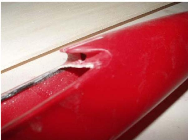
Rumpf mit der Bohrung für die vordere Flügelaufnahme
