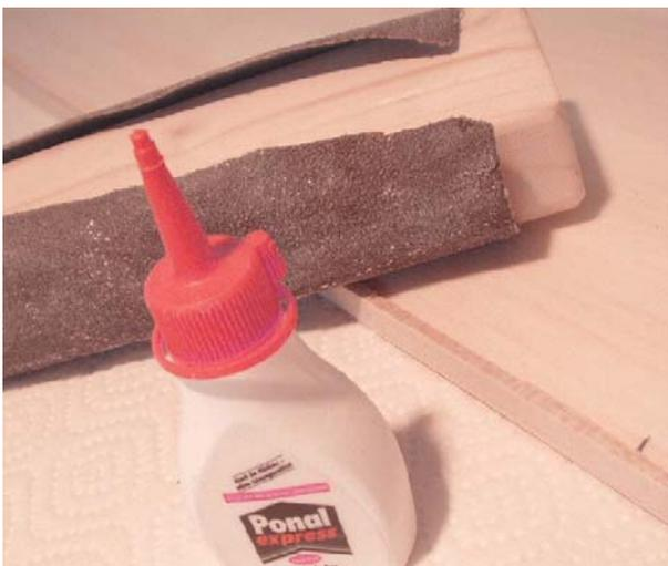
Nasenleiste an den Flügel kleben und verschleifen
