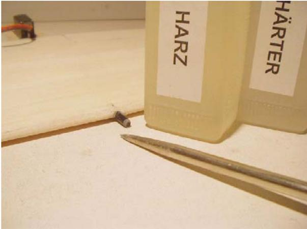
Das Loch für den Dübel 20mm tief in die Flügel Nase bohren und Dübel mit Epoxy einkleben
