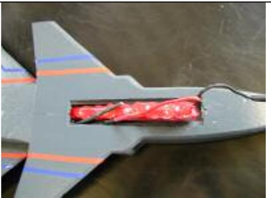
Die Kabinenhaube sollte abnehmbar gemacht werden, damit der Akku einfach gewechselt werden kann.
