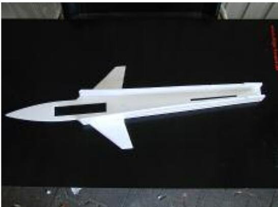
Anschließend kleben Sie den vorderen und den hinteren Deckel zusammen und setzen anschließend die beiden Seitenteile wie auf dem Foto gezeigt auf die Flügel.
