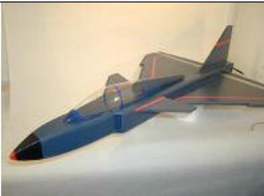
Das Auswiegen des Modells bildet den Abschluß der Bauphase. Dabei wird das Modell an der im Bauplan markierten Stelle unterstützt und sollte nun waagrecht liegen. Bei Verwendung der oben genannten Komponenten ergibt sich der Schwerpunkt fast automatisch.
