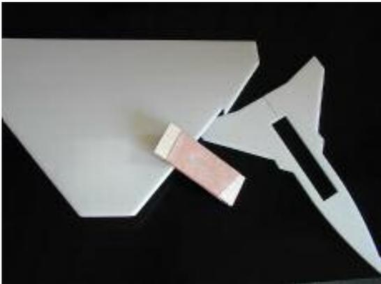
Zu Beginn des Baus der Gripen werden die Vorderkanten des Flügels und der Vorflügel (Canards) angeschliffen.
