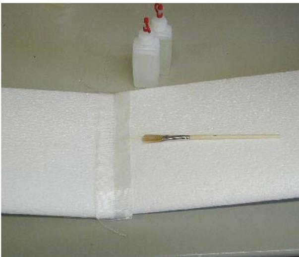
Mit 5 min.-Epoxy-Kleber wird nun die Tragflächenverstärkung angebracht. Achten Sie bitte auf die Anleitung Ihres Klebers. Kleber anrühren und mit einem Pinsel aufbringen. Das Glasgewebeband auflegen, mit dem Pinsel andrücken und nochmals auf das Glasgewebe ein wenig Kleber auftragen, bis es gut durchtränkt ist.
