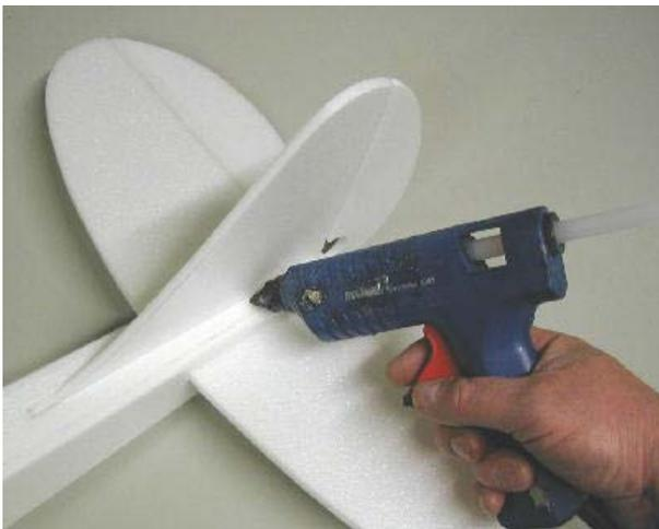
Seitenruder rechwinkelig ausrichten (von vorne über das MOdell schauen) und mit Heißkleber oder Epoxy festkleben.
