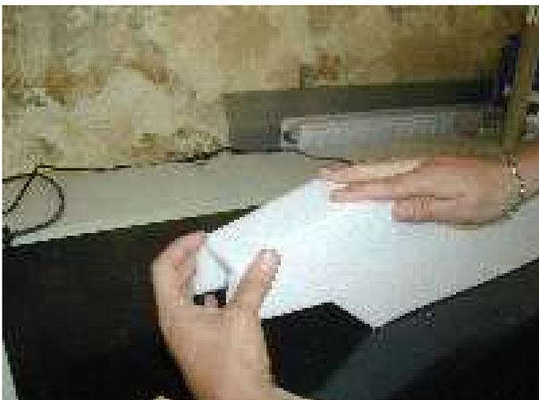
Pressen Sie nun die Platte in den Rumpf achten Sie dabei, dass die Platte gerade im Rumpf eingeklebt wird
