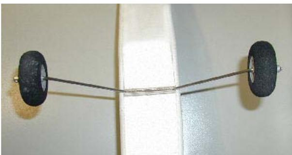
Das Fahrwerk in den Schlitz im Rumpfboden einkleben. Messingröhrchen auf den Fahrwerksdraht, Räder aufsetzen und mit Stellring sichten.
