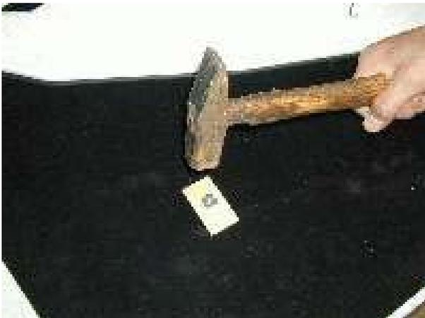
montieren Sie die Einschlagmutter mit der Tragflächenbefestigung
