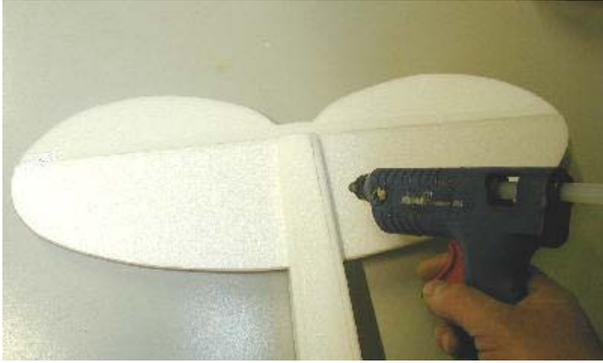
Höhenleitwerk rechtwinkeling ausrichten und mit Heißkleber oder Epoxy festkleben.
