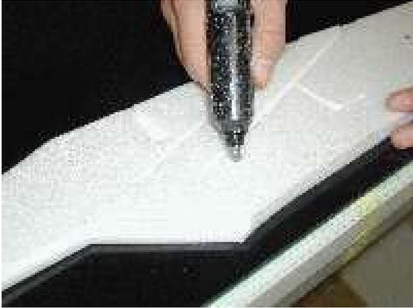
Bevor Sie die die beiden Seitenwände mit einander verleimen vergewissern Sie sich ob alle Teile zusammen passen in dem Sie die Beiden Seitenteile ohne Heißkleber zusammenstecken
