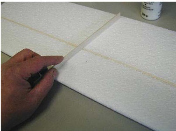
Den Holm in die Fläche drücken. Der Holm soll mit der Tragflächenunterseite bündig sein.
