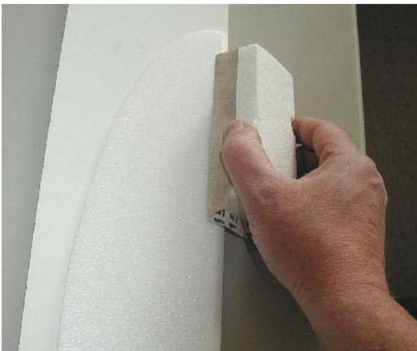
Die Höhenruderdämpfungsfläche auf ein scharfkantiges legen, an der Kante ausrichten und mit dem Schleifklotz die Hinterkante ca. 45° Grad anschrägen. Durch das Auflegen auf dem Brett bleibt die Hinterkante gerade.
