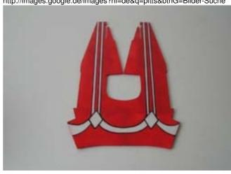
Das Rumpf-Material "Selitron" läßt sich sehr gut biegen ohne zu brechen. Biegen Sie es über einer runden Tischkante vor.
