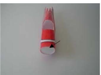
Motorspant von innen einschieben und verkleben.
