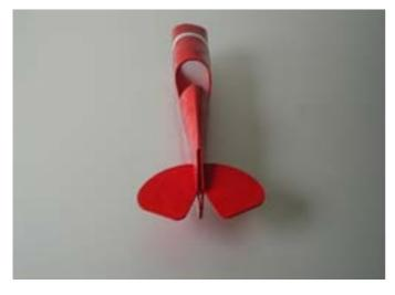
Höhenruder in den Spalt einschieben, ausrichten und verkleben.
