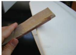
Um optimale Flugeigenschaften zu erhalten schleifen sie die Flügelvorderkanten mit 120er Schleifpapier etwas an.
