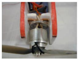
Der Motoreinbau ist stark abhängig vom Motor. Für Motoren mit Frontmontage ist aus Sperrholz ein entsprechender Spant zu sägen, Für den Mini-LRK reicht ein Depronspant mit einer Holzleiste als Verstärkung für die Befestigungsschrauben.
