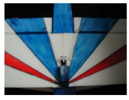
Das Querruder- Servo wird von unten in die untere Fläche eingebaut. Anlenkungen aus 0,8 mm Stahldraht führen dann zu den Rudern. In diese Anlenkungen sollte man einen Bogen biegen, um die Länge genau anzupassen.
