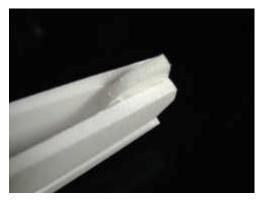
Kleben Sie nun den ausgeschnittenen Sporn unten hinten zwischen die beiden Rumpfhälften.
