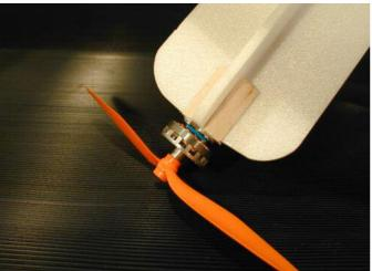
Die Motorbefestigung richtet sich nach dem von Ihnen verwendeten Motor.
