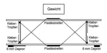
Die Pitts erhält Ihre sehr hohe Festigkeit ganz wesendlich durch eine Flügelverspannung. Die Eiligen stecken 1mm Kohlestäbe durch die Flächen und verkleben diese. Eine zweite, elegantere Möglichkeit ist die Herstellung einer Verspannung aus Schnur aus stabilem Nähgarn ö.ä.
