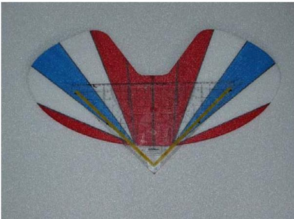
Anschließend wird die Mittellinie des HLW ermittelt und das Ruder angezeichnet
