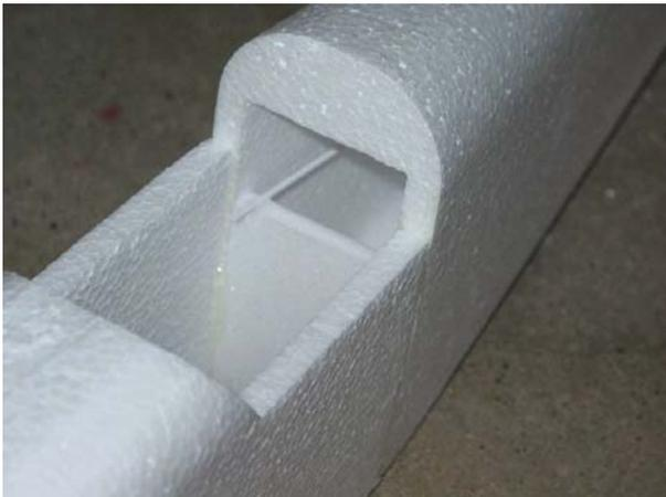
Die Bowdenzugrohre liegen auf dem Spant auf und werden auf der Oberseite verklebt.
