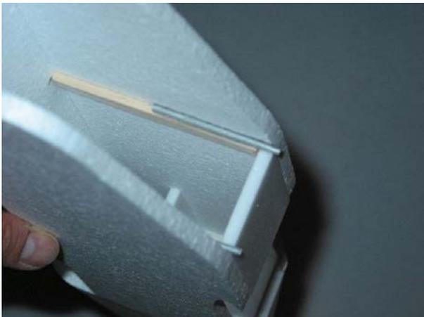
Anschließend werden die beiden 3 x 2 x 60 mm Aluröhrchen satt mit Rumpf und Leiste verklebt. Dabei stehe sie ca. 1 mm über den Rumpfboden über.
