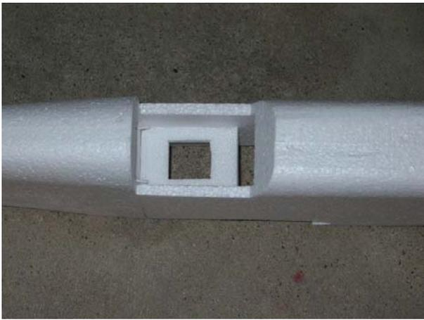
Das Servobrett ( 50 x 70 mm) aus der 6 mm Depronplatte ausschneiden und mit einem Ausschnitt passend zu den Servos versehen. Danach das Servobrett ca. 30 mm unterhalb des Rumpfrands einkleben.
