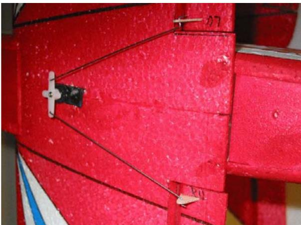
In diesem Ausschnitt wird das Servo entweder mit Schrauben oder mit einigen Tropfen Klebstoff befestigt. Danach werden die Gestänge aus 0,8 mm Stahldraht gebogen. Am besten wird der Draht erst passend gebogen und dann an beiden Enden gekröpft. Für alle die sich das nicht passend zutrauen gibt es mit dem nächsten Bild noch einen Tipp.
