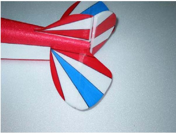
Anschließend wird das Seitenleitwerk in den Schlitz auf dem Rumpfrücken eingeschoben, bis es auf dem Höhenleitwerk aufliegt. Auch hier muss eine Ecke ausgeschnitten werden, damit sich das Höhenruder bewegen kann.
