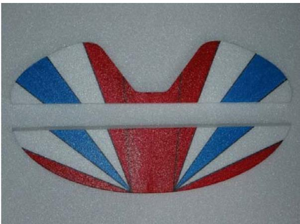
Höhenruder abtrennen und am Leitwerk ca. 5mm abschrägen. Anschließend das Ruder mit 19 mm breitem Tesafilm als Scharnier von oben wieder ankleben. Wenn das Ruder so einen ausreichenden Ausschlag erreichen kann, kann man von innen noch zwei 5 cm lange Streifen dagegenkleben.
