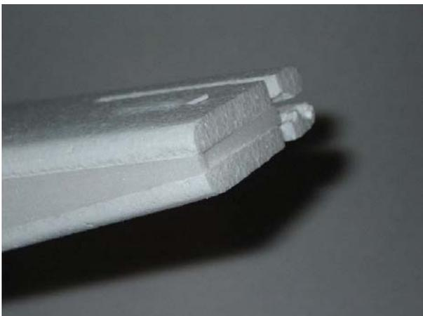
Der fertige hintere Rumpfboden und der hintere Rumpfabluß können nun eingeklebt werden
