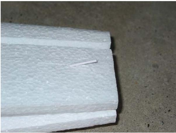
Anschließend werden im Heck die beiden ca. 3 cm langen Schlitz für die Bowdenzüge mit einem scharfen Messer geschnitten.
