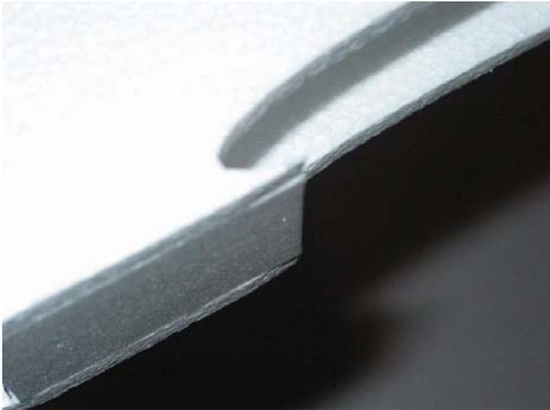
Nun den mittleren Rumpfboden ( 70 x 50 mm) aus der 6 mm Depronplatte ausschneiden und passend zum Flächenübergang anschrägen. Nach der Anprobe einkleben.
