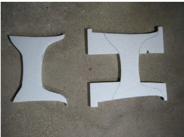
In der Trockenpause werden die Baldachinstreben schon einmal ungefähr auf Form geschnitten. Die Kerbe in den Streben markiert „vorn oben“. Wenn gewünscht können die Streben noch filigraner geschnitten werden, allerdings wirkt sich das negativ auf die Verwindungssteifigkeit des Modells aus.
