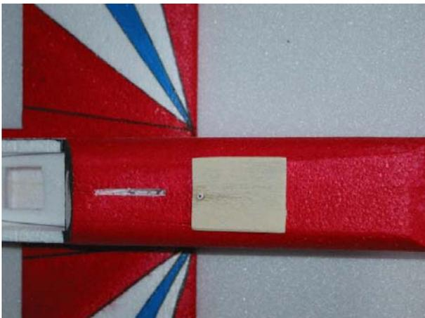
Ca. 10 mm vor dem Kabinenausschnitt kommt für die mittlere Strebe ein Schlitz von 3 x 50 mm in den Rumpf. Die Sperrholzstrebe soll sich stramm in den Schlitz einschieben lassen. Oben in die Strebe ein 3 mm Loch für das Bowdenzugröhrchen bohren und das Rohr einkleben.
