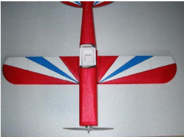
Jetzt wird die untere Fläche am Rumpf rechtwinklig zur Längsachse ausgerichtet und angeklebt
