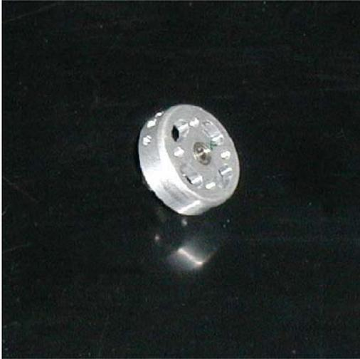
Kugellager mit Loctite in den Statorträger einsetzen. Nur sehr wenig Loctite verwenden und darauf achten, das kein Kleber auf die Stirnseite des Lagers kommt.
