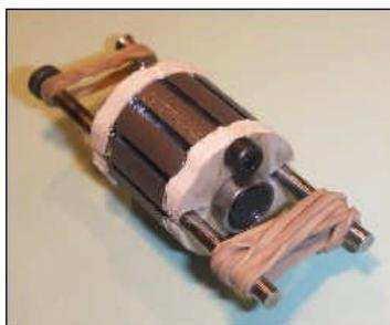
Dünne gefettete AL-Folie zwischen Blech und Preßplatte sowie das vorherige leichte Fetten der Statorhülse verhindert ein späteres Festkleben der Teile am Blechpaket.
