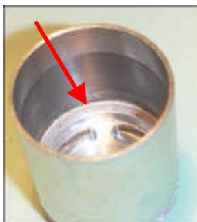
Um den zukünftigen Magneten auch eine axiale Anlage zu ermöglichen, die sicher stellt, dass die Magnete die gleiche axiale Lage wie das Statorpaket erhalten, sollte man vor dem Einkleben der Magnete sich ein Bezugsmaß schaffen. Dazu schneidet man sich ähnlich der Abstandshalter aus dünnem 1,5mm Balsa einen Balsastreifen, der in Abhängigkeit des zu bauenden Motors folgende Maße haben sollte:
