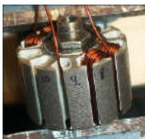
In gleicher Weise verfährt man mit den anderen beiden Wicklungsparen, für die Zähne 3/9 (bzw. 3-4/9-10) sowie 5/11 (bzw. 5-6/11-12) bis der gesamte Stator bewickelt wurde.
