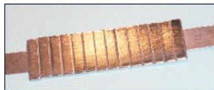
Der Arbeitsplatz sollte sauber und frei von herumliegenden Kleinteilen sein. Alle Magnete werden der Reihe nach auf ein sauberes, fettfreies Stahlblech o.ä. aufgelegt, so daß sich alle Magnete anziehen. Mit feinem Sandpapier wird eine Oberfläche angeschliffen und anschließend der Schmirgelstaub mittels Tesafilm „abgetupft“. Auch die Innenseite der Stahlhülse sollte zwecks besserer Kleberhaftung angeraut werden.
