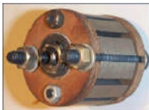
Nun kann das Paket wie bereits oben beschrieben, im Ofen bei 150°C ca. 45 Minuten „zusammengebacken“ werden. Auch hier sollte zwischendurch die Schraubenspannung kontrolliert werden.
