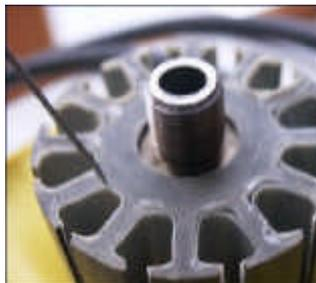
isoliert somit die gefährlichen Kanten. Wer es ganz exakt betreiben will, fixiert das Isolierpapier noch mit Sekundenkleber, indem das Papier an die Wandung der Nut angedrückt wird. So kann man sicher ausschließen, dass beim Wickeln die Isolierung verrutscht. Aber achten sie unbedingt darauf, dass die Statorhülse nicht festgeklebt wird. Am besten, man entfernt sie vor den Klebearbeiten.
