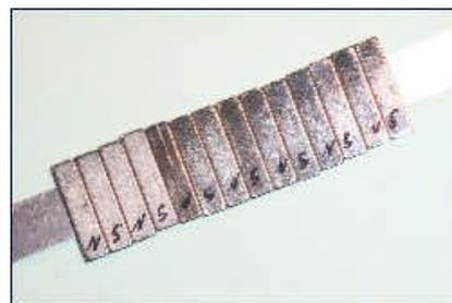
Entsprechend der vorgegebenen Reihenfolge werden nun die Magnete in den Stahlring eingelegt. Zuvor müssen aber noch passende nichtmagnetische Abstandshalter gesucht oder angefertigt werden. Bei einem 14-poligen 350-er Motor mit 6mm breiten Magneten ergibt sich ein Abstand von ca. 2,3mm, Kleine Kabelbinder haben genau diese Breite. Bei einem 10-poligen 430-er mit 2x5mm breiten Magneten ergibt sich ein Abstand von ca. 4,2mm. Man sich den richtigen Abstand auch ausrechnen:
