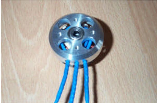
Die vier Befestigungslöcher ermöglichen eine Vielzahl von Kabelführungen.
