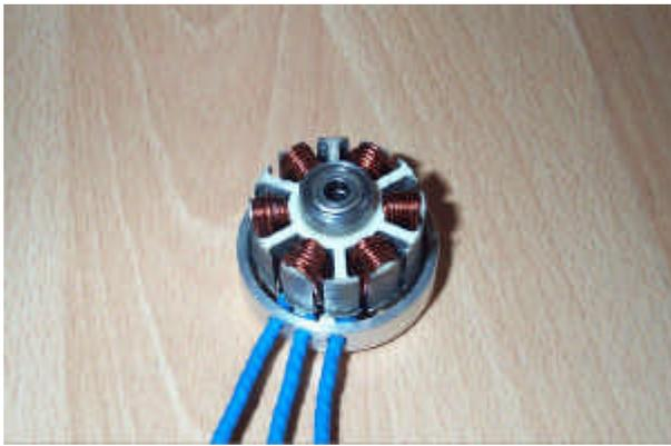
Die Drahtenden werden mit Schrumpfschlauch isoliert. Nun drei Löcher am Statorrand so anbringen, das die Kabel für Ihr Modell, an der günstigsten Stelle herauskommen. Die Statorhülse kann nun verschraubt werden. Wichtig hierbei, bitte das Kugellager vorher einsetzen, damit der Schraubenschlüssel nicht den Lagersitz verzieht. Nach dem Probelauf sollte die Statorhülse mit Sicherungslack versehen werden.
