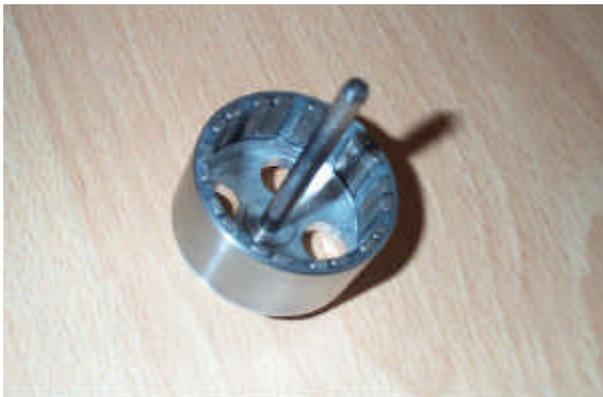
Den Rückschlussring innen aufrauen und mit dem Lagerschild verkleben. Uhu Endfest oder Loctite 648 ist hierfür gut geeignet. Nun werden die Magnete eingeklebt.
