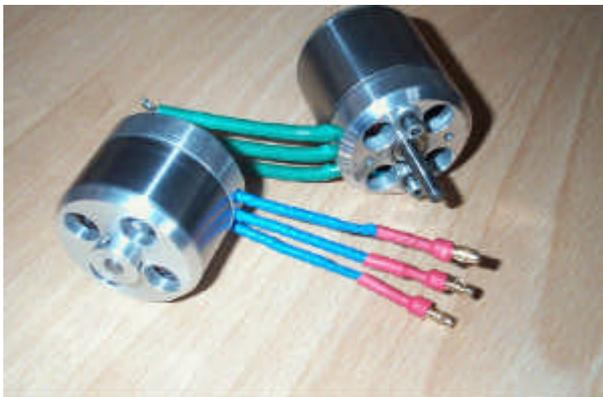
Evt. die Welle auf der Bohrmaschine noch mit 400er Papier nacharbeiten, damit diese saugend in die Lager passt. Die Länge bitte vorher bestimmen, damit keine Späne in die Nähe des Rückschlusses oder der Magnete kommen.
