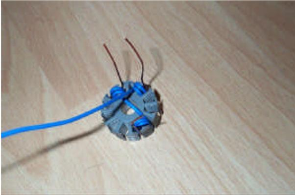
Für die sichtbaren Brücken sollte genug Draht stehen bleiben, damit diese später so gelegt werden können, das die Statorhülse dran vorbei kommt. Hier ist Zahn 9 auch fertig.
