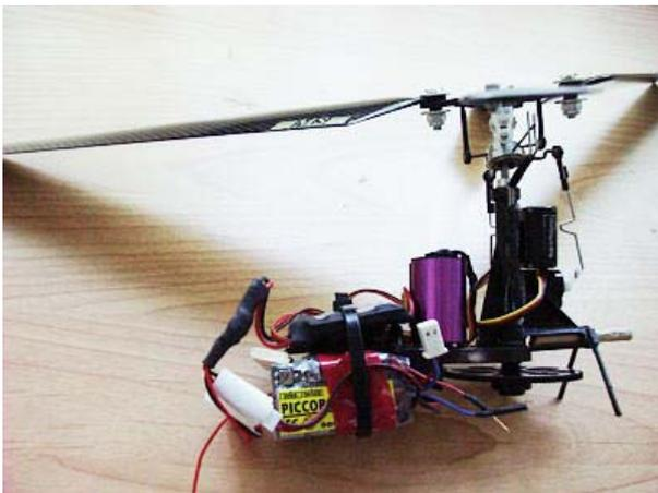
Dabei handelt es sich um im Grund um das Heckrohr beraubte Mechanik mit vorne entfernten bzw. hinten gekürzten Kufenstreben.
