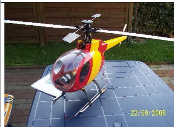
Bild 8 hier sieht man den fertigen Hughes 500 mit eingebautem Akku.
