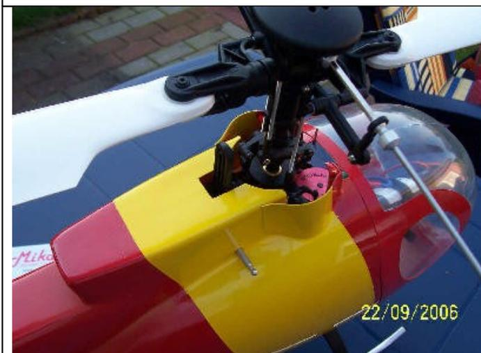
Bild 7 zeigt den Hauptrotor mit Taumelscheibe und die original Haubenbefestigung.
