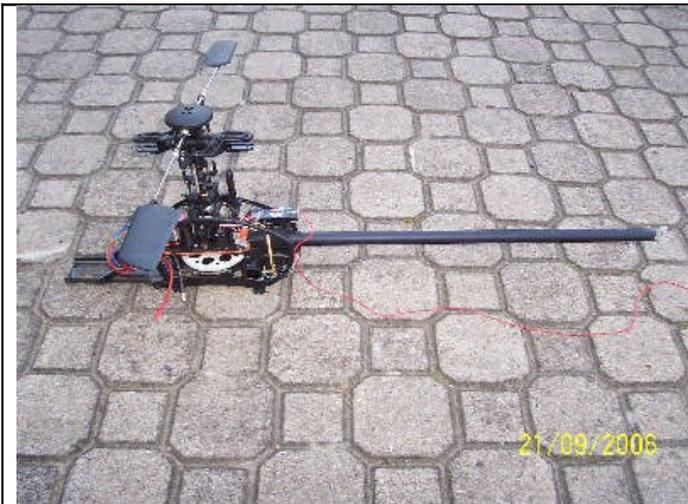
Zuerst am Logo Rotorblätter, Heckrotorgehäuse, Heckrotoranlenkung und Fahrgestell demontieren (Bild 1).
