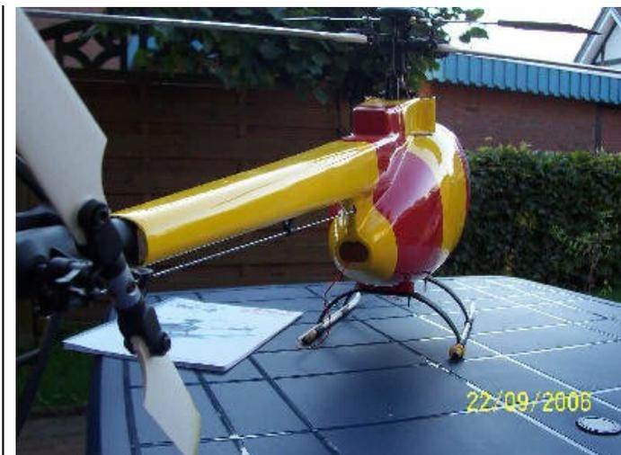
Im Bild 6 sieht man den Heckausleger mit Steuergestänge. Die Halterung der Steuerstange wurde aus der original Halterung gefertigt und mit Sekundenkleber am Rumpf befestigt. Das Loch im Heck dient der zusätzlichen Belüftung und als Führung für die Antenne.
