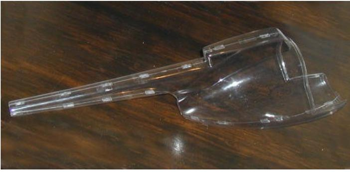
Die beiden Hälften zusammenfügen und Punkt für Punkt verkleben. Dazu ev. mit einem Stab von innen ein wenig gegendrücken. Die Halbschalen sollen überall voreinander stossen. So kann man die beiden Hälften rundum mit dünnem Sekundenkleber verkleben.
