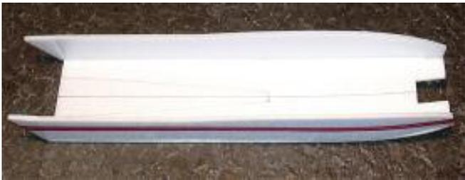
Die hinteren Seitenwände einkleben, vorher das Bodestück etwas rund biegen, hier empfiehlt sich das Kontaktkeben mit UHU-POR, wer mag kann auch hier die Balsadreikantleisten einbauen,
