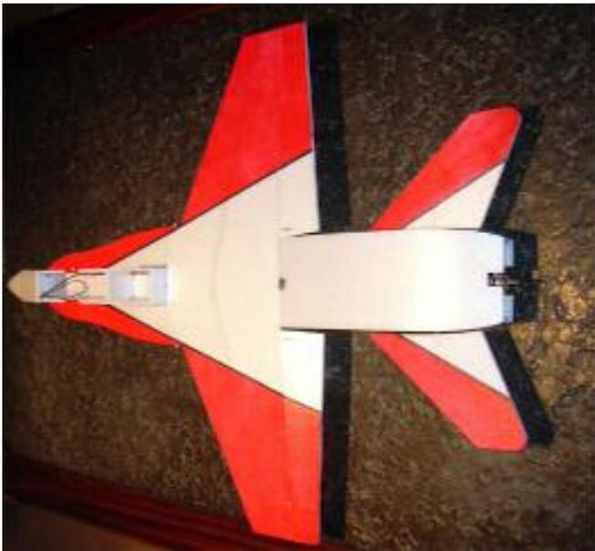
Tragfläche, Vorflügel und hinteres Rumpfberteil einkleben, Querruderanlenkung einbauen, **+/-20mm sind ausreichend,**
