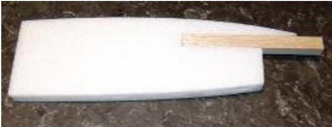
die beiden Motorträger verkleben, Kieferleiste 10x10x85mm einkleben, den Motorträger dem gewähltem Motor anpassen, beide Rumpfteile verkleben, den Motorträger an das Vorderteil ankleben, Motor einbauen,
