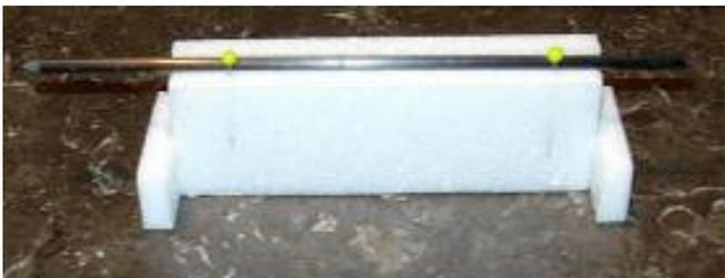
die Position der Löcher ist 90 mm vom Rumpffende und 29 mm vom Rumpfboden entfernt anzeichnen, dann Bau einer Lehre für die Löcher der Höhenruderverlagerung, Höhe 27,5 mm Rest siehe Bild links,
