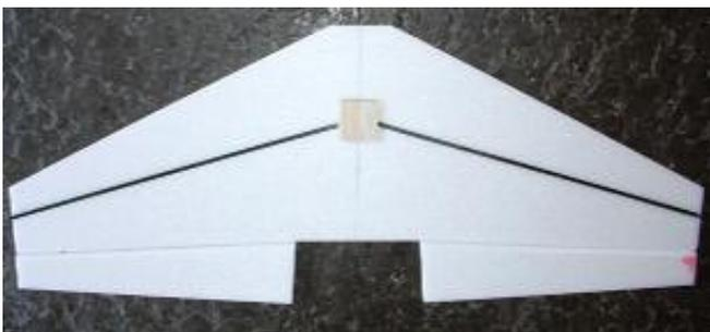
Mit 30x30x3mm Balsahölzern (nicht im Bausatz enthalten) zwei Verstärkungen auf und unter die Holmmitte kleben, Querruder anschleifen und anschlagen,
