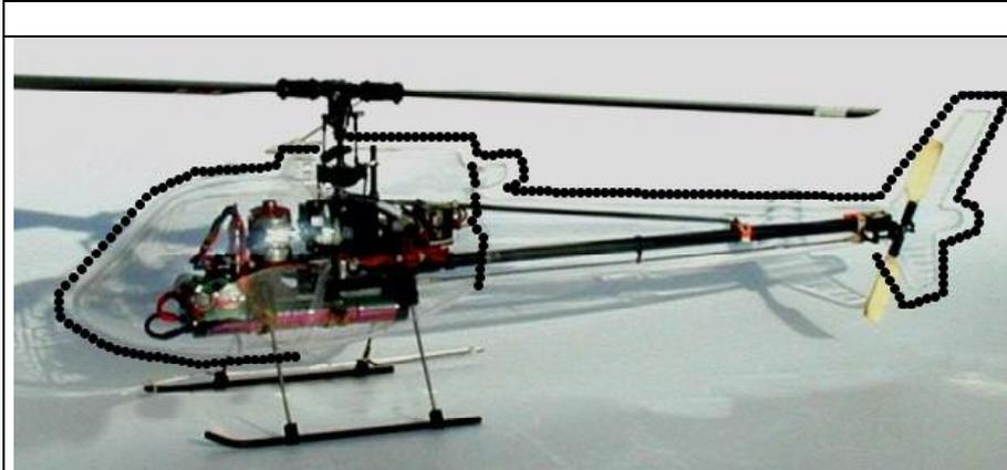
Die Rumpf-Teile mit Tesa-Film fixieren. Die gepunktete Linie zeigt die Stellen, an denen der Rumpf mit Sekundenkleber fest verklebt wird. Die restlichen Fugen bleiben offen und werden nach der Montage auf dem Chassis mit Tesafilm verschlossen.
