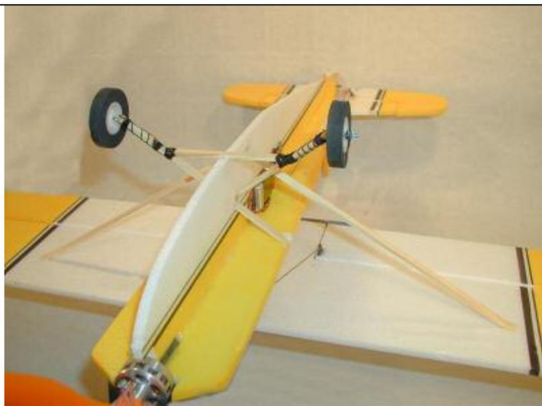
Den Fahrwerksdraht mit Sekundenkleber auf den Leisten fixieren.
