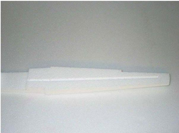
Im ersten Schritt bekommen die beiden Rumpfhälften innen einen Kanal für die Bowdenzüge. Diesen Kanal schneidet man am besten mit einem scharfen Bastel-messer V-förmig in das Styropor. In der Rumpfmittle enden die beiden Schnitte jeweils ca. 3 cm unterhalb der Oberkante. Hinten brauchen sie nicht bis zum Ende durchzugehen. Der Kanal für die Höhenrudernanlenkung endet ca. 6 cm vor dem Ende, der Kanal für die Seitenrudernanlenkung endet ca. 3 cm vor dem Rumpfenende.
