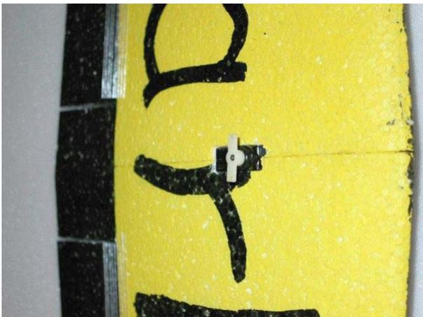
Das Servo selbst wird dann mit etwas Kleber, egal ob Sekundenkleber oder Heißkleber gesichert. Das Servo Kabel wird auf der Flügelunterseite aus dem Flügel geführt.
