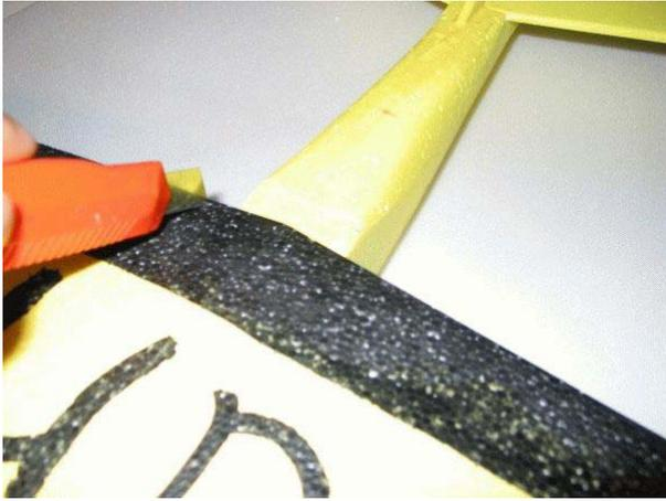
Wenn der Flügel aufgeklebt ist, werden die Querruder wieder mit dem scharfen Messer ca. 5 mm von der Rumpfsseitenwand entfernt eingeschnitten. Damit sich alles perfekt bewegen kann macht man am besten zwei Schnitte im Abstand von ca. 1 mm. Die Scheibe aus dem Spalt wird dann entfernt.
