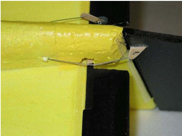
Mit den Anlenkungen sieht es dann so aus. Wie bei den Querrudern sind die Ruderhörner aus dem Sperrholzbrett geschnitten und die Drähte sind passend abgekröpft.
