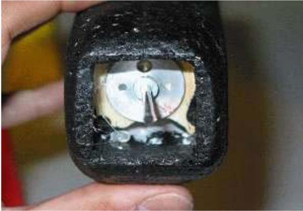
An den Spant wird dann der Statorhalter angeschraubt. Zum Ausrichten nimmt man entweder den kompletten Stator des Mini-Lrk oder nur einen Stahldraht entsprechender Stärke.
