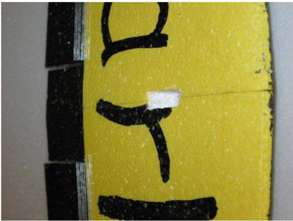
Am oberen Bildrand erkennt man gut das Klebeband über der Scharnierstelle der Querruder. Strapping Tape eignet sich sehr gut weil es gut auf dem Styropor hält, aber auch normales Tesa klebt gut, wenn man das Styropor vorher dünn mit Styrozack einstreicht.
