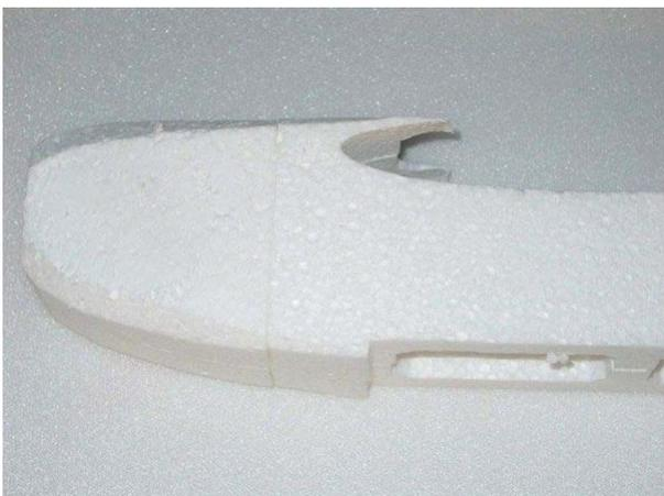
Mit unserem scharfen Messer kann die Rumpfnase schon einmal grob gerundet werden, die endgültige Form kommt dann aber erst nachdem die Bodenklappe fertig ist. Dann wird der Rumpf mit 240 Schleifpapier verrundet.
