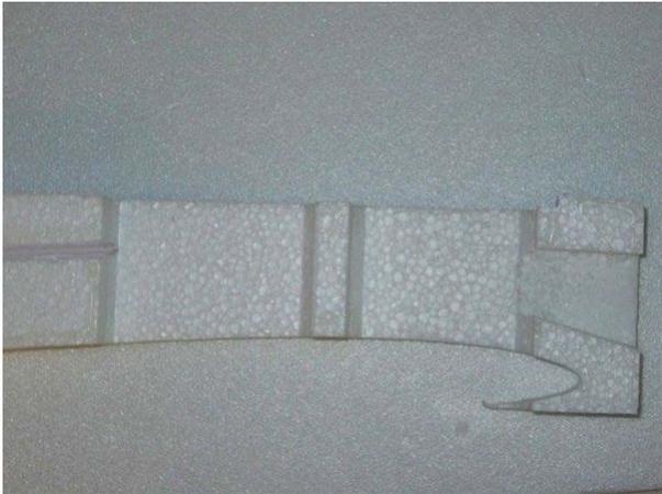
Am vorderen Ende werden die Seiten so ausgeschnitten, dass sich ein breiter Durchgang zum Motorraum ergibt. Der Durchgang muss so groß ausfallen, da dort nachher der Fahrtregler eingebaut wird. Am besten legt man das entsprechende Seitenteil der Rumpfnase an, um zu sehen, wie groß der Kanal sein muss und wo er auskommen sollte.
