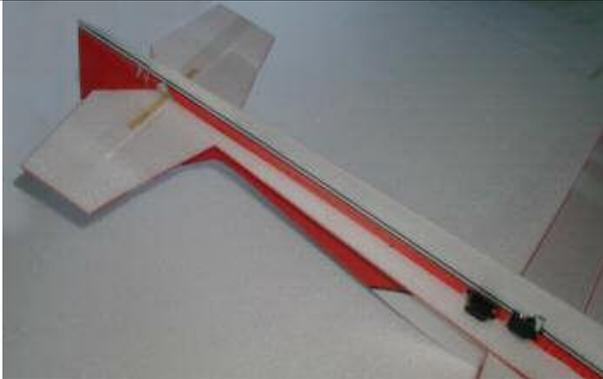
Alle Teile wie Motor, Akku, Empfänger, Servos provisorisch am Modell befestigen, um die richtige Verteilung zu finden. Die Einzelteile so aufteilen, daß der Schwerpunkt bei 65-70mm hinter der Nasenleiste liegt.
