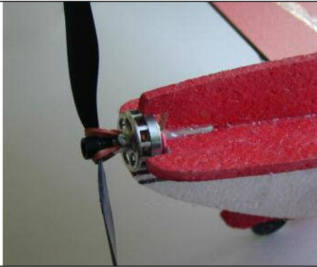
Für den Motoreinbau gibt es viele Varianten. Für den hier verwendeten Motor High-Torque 240/5 wird nur das EPP ausgeschnitten und der Motor mit dem Halteröhrchen direkt eingeklebt.
