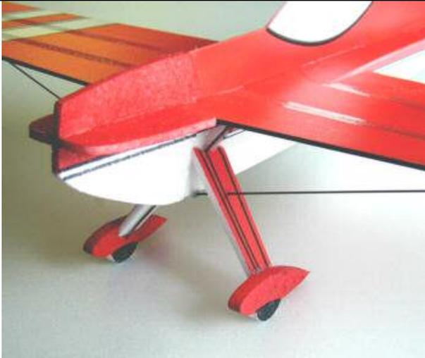
Dann die Fahrwerksverkleidung ankleben, diese geben dem Fahrwerk sehr gute Stabilität. Zum Schluß die Radschuhe ankleben. Überprüfen Sie vorher, ob das Modell gerade steht. Überschüssige Kohlestange abschneiden.
