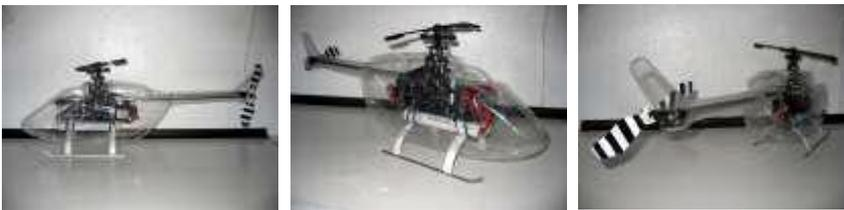
Die Rumpfteile sind jetzt am Hubschrauber angepasst. Schneiden Sie oberhalb des Motors Kühlöffnungen aus (die vorgestanzten Fenster z. B.) und kontrollieren sie nochmals die Passgenauigkeit. Schneiden sie Rumpfkanten nun passgenau aus. Montieren Sie die Rotorblätter und prüfen ob sich alle drehenden Teile frei bewegen lassen. Lässt sich der vordere Rumpfteil für den Akkuwechsel schnell abnehmen?
