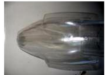
verkleben indem die Spitze der Klebetube unter die Naht geführt wird. Kleine Mengen Klebstoff zufügen und zusammen drücken. Immer Stückweise um gegebenenfalls Korrekturen ausführen zu können.
