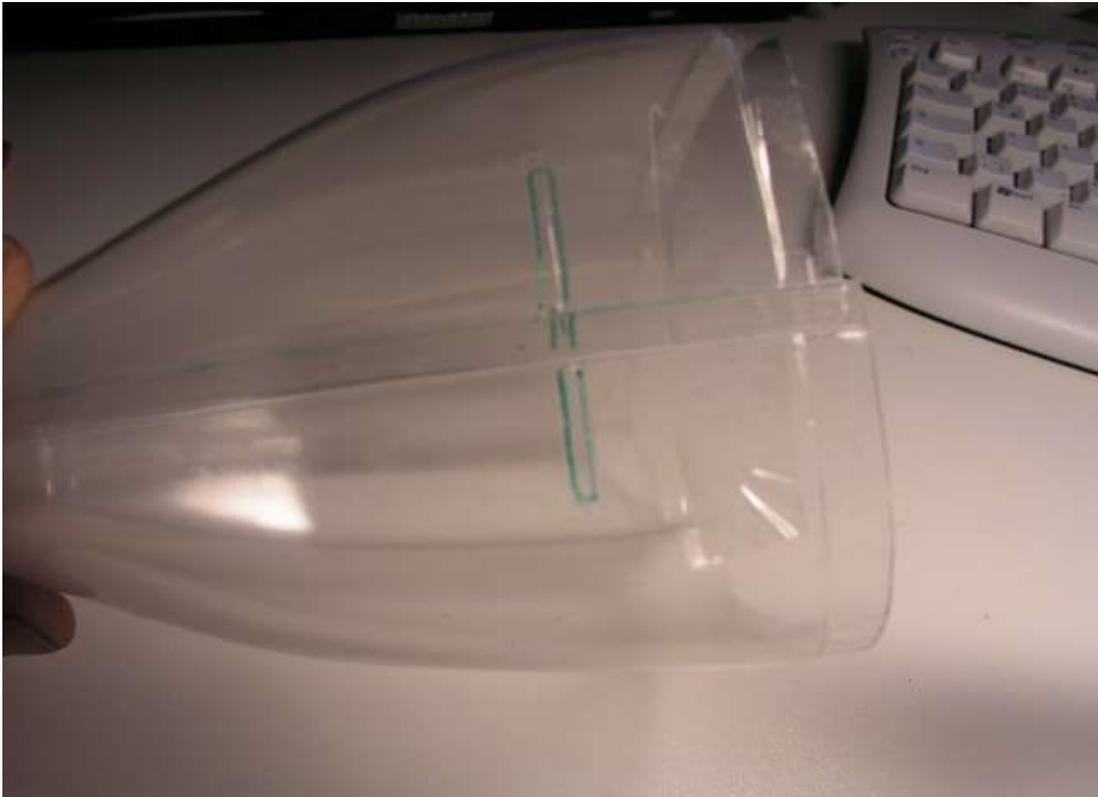
Nach Trocknung des Klebers wird die Aussparung für die Befestigung des Heckrumpfteils ausgeschnitten. Die Strebe des hinteren Landegestells wird etwas gelockert, damit der Rumpf dort gut reinpasst.
