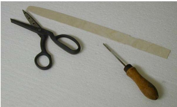
Den 0.8 mm Sperrholzstreifen mit Schere und Feile zuschneiden und zur Kontrolle in die Rumpfnase einführen.
