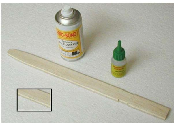
Mit dickflüssigem Sekundenkleber beide Teile verkleben. Dazu auf dem Sperrholz den Sekundenkleber aufbringen, das Balsa mit Aktivator einspühen. Dann zügig beide Teile zusammendrücken. Es soll an den Außenseiten eine Kante von ca. 1mm entstehen. (siehe Vergrößerung)
