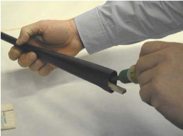
Mit dünnem Sekundenkleber verkleben. Anschließend das überstehende Balsa vor der Einschlagmutter abschneiden.
