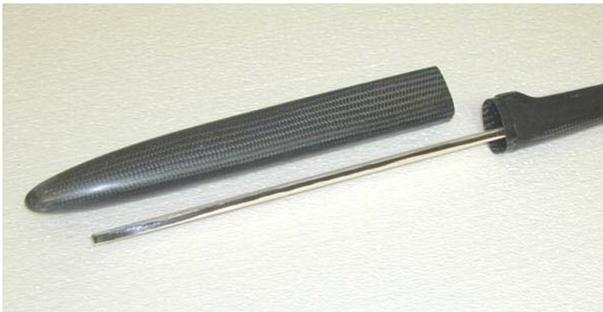
Das fertige Nasenboot leicht verkanten, in den Rumpf einführen und wieder drehen. Wenn das Sperrholzteil vorher schon gepasst hat und der Rowing nicht übersteht, sind keine Nacharbeiten erforderlich. Das Boot NOCH NICHT verkleben!
