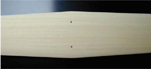
Die Schrauben, welche den Flügel mit dem Rumpf verbinden, sind auf der Oberseite des Flügels versenkt.
