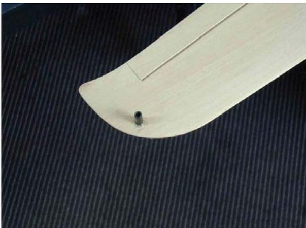
Anschließend wird noch der Wurfpflock im Abstand von 20mm vom Randbogen und 45mm von der Flügelvorderkante senkrecht in den Flügel geklebt, hier bitte auf eine präzise Bohrung achten.
