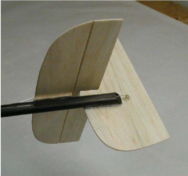
Die Dämpfungs-fläche des Höhenleitwerks auf das vordere Ende der Auflage kleben !!! Achtung, es empfiehlt sich die Höhenleitwerksauflage zuerst mit 3mm Balsa aufzufüttern, damit der Flapverbinder nachher frei beweglich ist !!!
