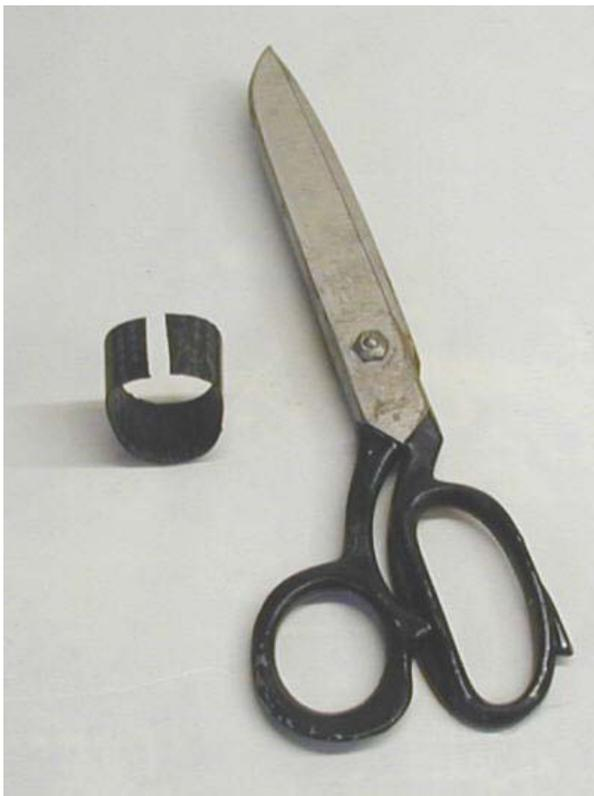
Den Kohle-Zwischenring mit einer Schere an der breiteren Seite (Unterseite) aufschneiden. Der Spalt sollte ca. 3-5 mm betragen.
