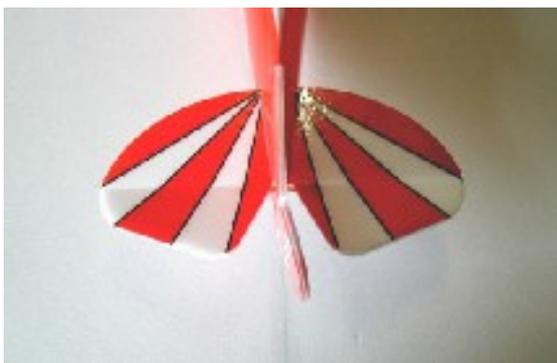
Leitwerke auf genügend Ausschlag kontrollieren, ev. die Ruderspalt ein wenig nachschleifen. Bis 30-40° Grad Ausschlag sollen sich die Ruder leicht bewegen lassen. Leitwerke einkleben. Es ist sinnvoll, hierzu die untere Fläche unter den Rumpf zu halten. So kann man mit einem Blick von vorne über das Modell die Leitwerke genau rechtwinkelig zu der Fläche ausrichten.
