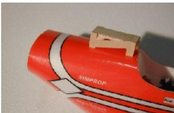
An den markierten Stellen den Rumpf einschneiden und den Baldachin einsetzen. Der Baldachin soll sich stramm bewegen lassen.
