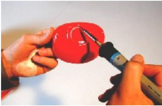
Die Motor- und Lüftungslöcher ausschneiden. Es hat sich sehr bewährt, diese Arbeit mit einem kleinen LötKolben durchzuführen.
