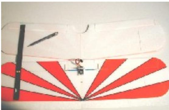
Die Position der Flächenverbinder ist auf die untere Fläche aufgedruckt.
