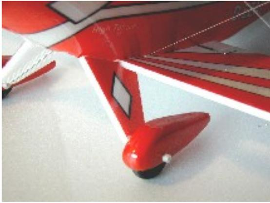
Die Fahrwerksverkleidung von innen und unten am Rumpf mit Klebeband befestigen, NICHT mit Klebstoff verkleben. Um Rumpf und Flügel wieder demontieren zu können, müssen die Fahrwerksverkleidung am Rumpf lösbar sein.
