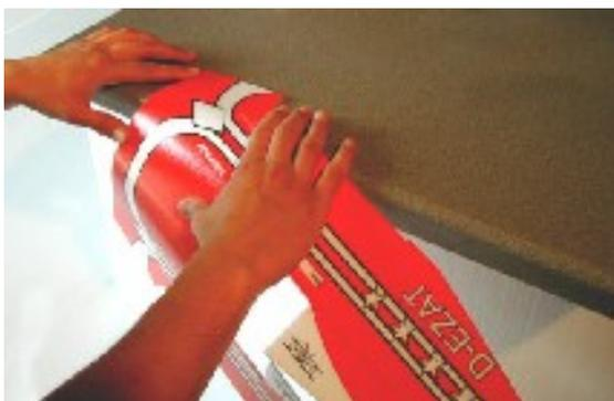
Die Rumpf-Unterseite leicht schräg ansetzen und mit wachsendem Druck reiben und biegen.
