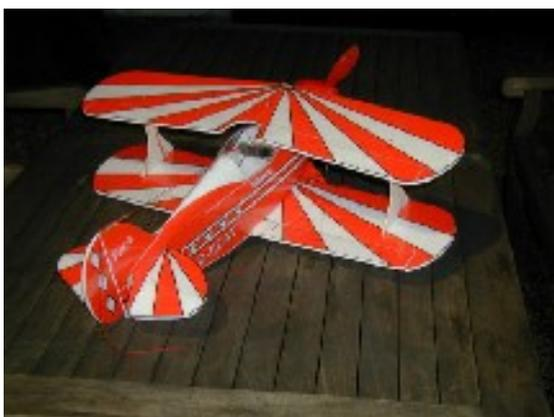
Schwerpunkt: 15-20 mm hinter der Vorderkanten des UNTEREN Flügels. Der Schwerpunkt ist optimal, wenn im Rückenflug nur ganz wenig gedrückt werden muss. Für den Erstflug mit 15mm beginnen.
