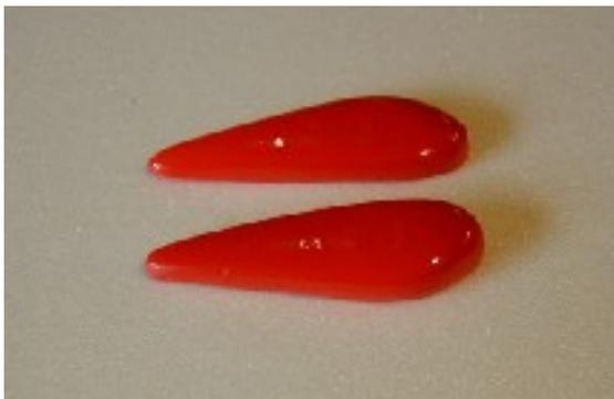
Radschuhe mit einer kleine Schere an der markierten Linie ausschneiden, zusammenkleben und den Radausschnitt einschneiden. Loch für den Fahrwerksdraht bohren oder mit einem kleinen LötKolben einbrennen.
