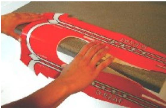
Über einer runden Tischkante den Rumpf in Form biegen. Hier kann man ruhig ein wenig fester drücken.. 5-10 mal mit wachsendem Druck das Selitron über die Kante reiben.
