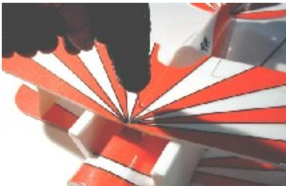
30 mm von der Vorderkante den oberen Flügel bohren
