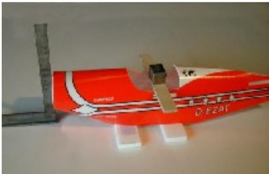
Den Rumpf mit den beigelegten Depronstreifen auf der unteren Flächenaufgabe auflegen und beschweren. Den Motorspant senkrecht rechtwinklig ausrichten.
