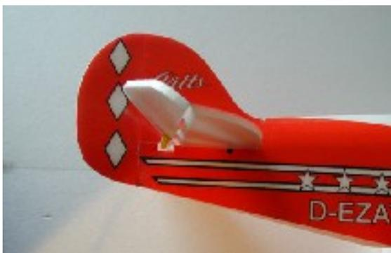
Der Rumpf hat rechts und links schwarze Punkte. Diese markieren die Durchbrüche für die Bowdenzüge. In Flugrichtung links wird der Bowdenzug für das Seitenruder durchgeführt, in Flugrichtung rechts der für das Höhenruder. Die Ruder einschlitzen und die Ruderhörner entsprechend einkleben.
