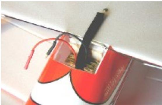
Das Klettband sichert im Betrieb den Akku UND das Fahrwerk.
